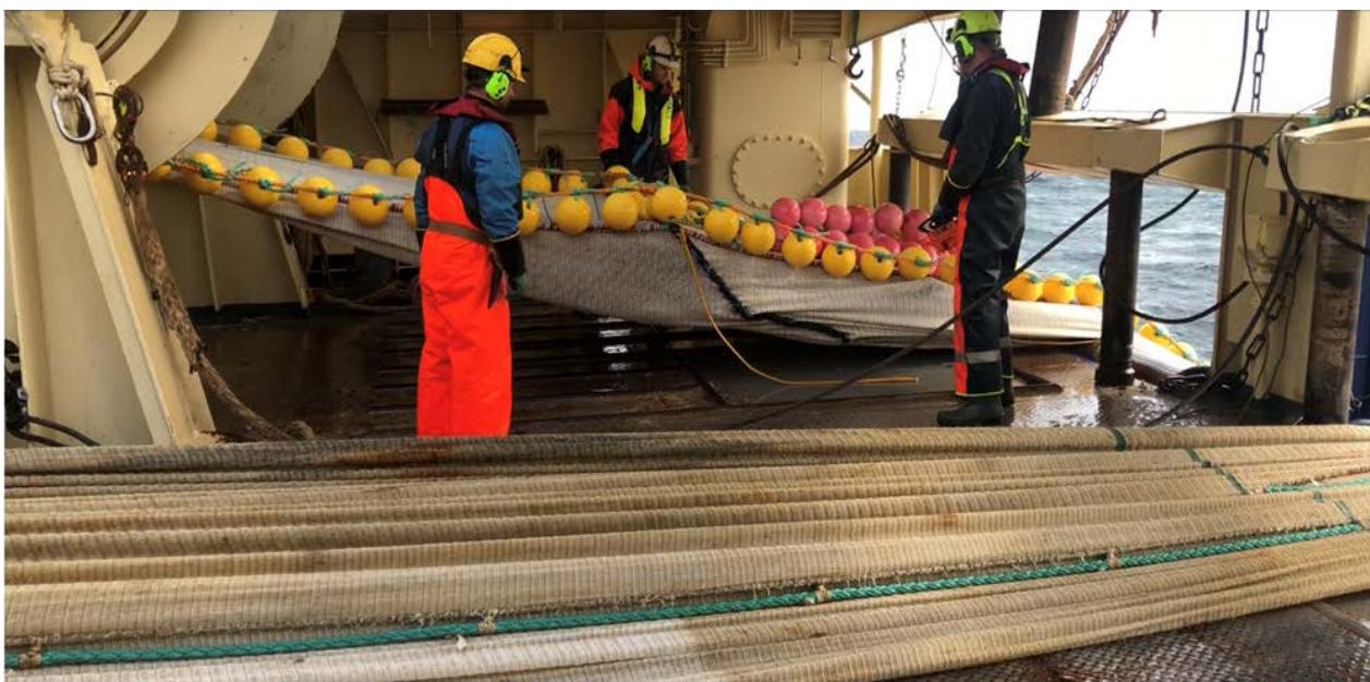
Figur 22: Bildet viser utsetting av dobbeltrål der vi sammenligner fangsten av en trål med en vanlig 1,8 m x 3,6 m seleksjonsrist mot fangsten av en trål med Excluder.
